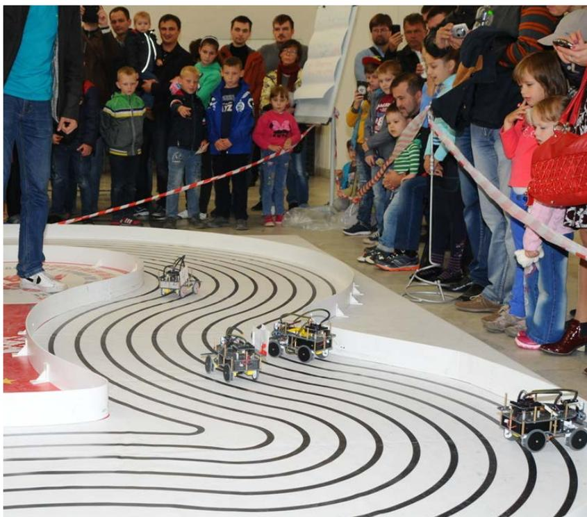
По краям трассы установлены борта трассы, чтобы робот, за счет использования установленных на нем датчиков расстояния, измерял расстояния до бортов трассы, анализировал полученные данные согласно созданной программе и таким образом мог передвигаться по трассе.
